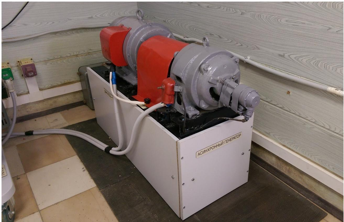
Рис. 5.3. Фотография исследуемого агрегата «Асинхронный генератор – приводной двигатель постоянного тока» (номинальные данные – см. рис. 5.1, лист 1 и 2)
