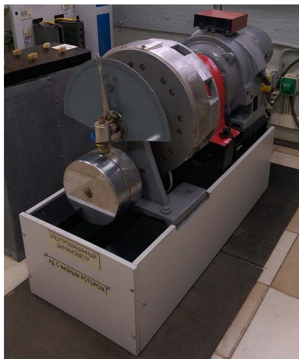
Рис. 2.5. Фотография исследуемого агрегата «Трехфазный асинхронный двигатель с фазным ротором – электромашинный динамометр» (номинальные данные – см. рис. 2.1)
